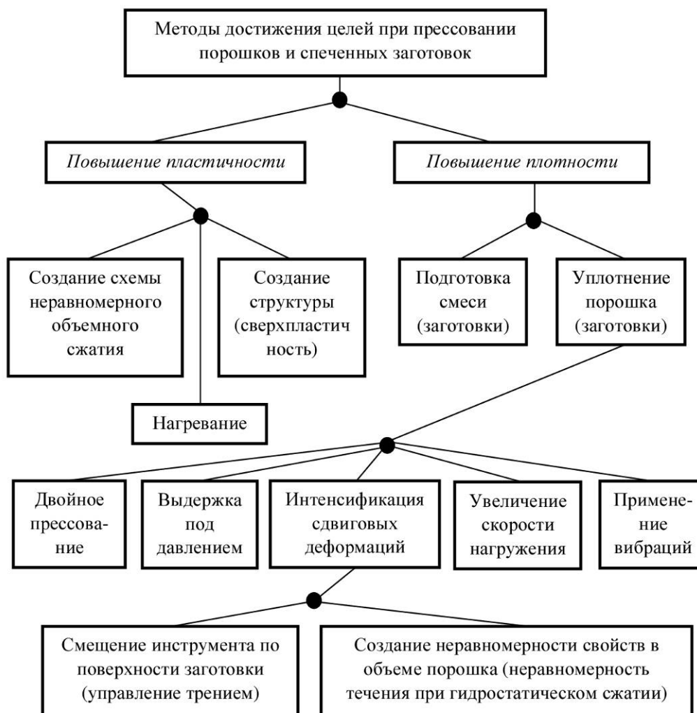
Рис. 1. Методы повышения плотности и пластичности порошковых материалов и заготовок при обработке давлением
